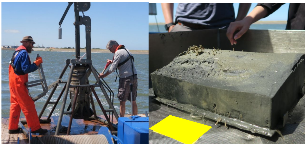
Figuur 1. Boxcore aan boord van RV Navicula, met een voorbeeld detailopname van een boxcore sample. Het oppervlak bodem dat de boxcore bemonsterd is 20 × 30 cm. In de linker bovenhoek van het monster steken woonbuizen van Lanice conchilega boven het sediment oppervlakte uit.
