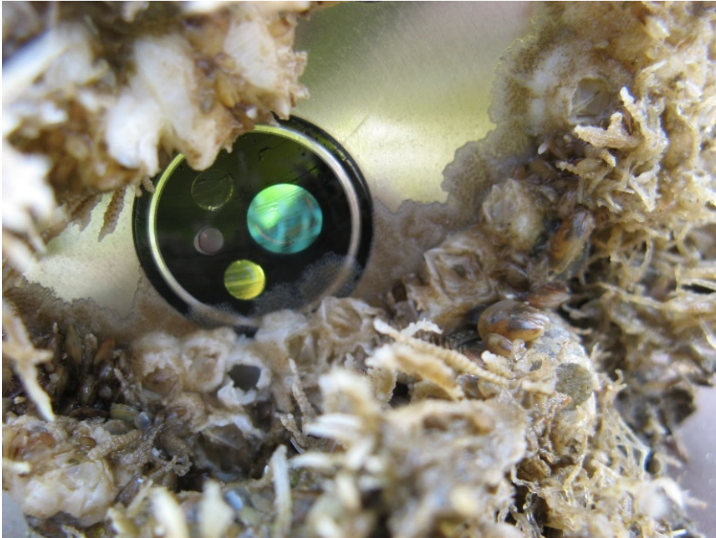
Figuur 5. OBS sensor waarvan het ruitensissertje het eigenlijke sensor oppervlak heeft vrijgehouden van aangroei gedurende het grootste deel van de deployment periode.
