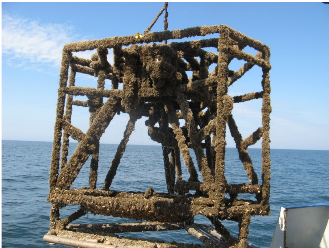
Figuur 3. Recovery van het meetframe dat 3 maanden heeft gestaan op de Slowmill locatie, totaal overgroeid door epifauna.
